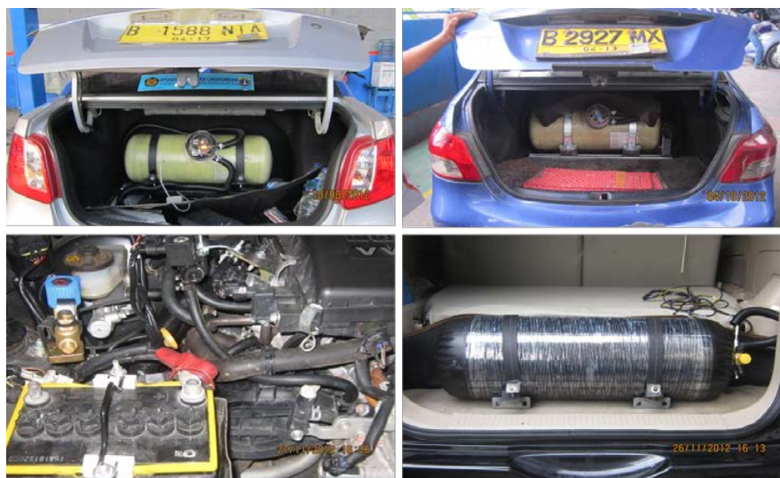
Gambar I-18 Pemasangan Konverter Kit
